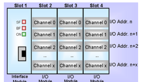
Figure 6 : Similitude du modèle d'équipement PROFINet IO et PROFIBUS DP
